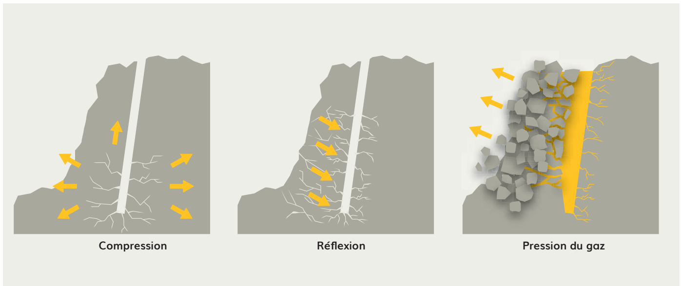
Figures 1-3: Fragmentation de roche dans une explosion normale
