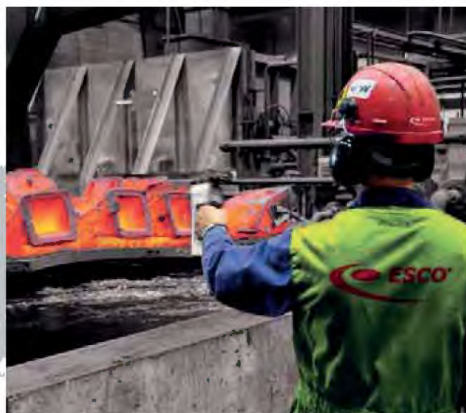
Un contrôle continu post-production est assuré afin d'éliminer les pièces non-conformes.
