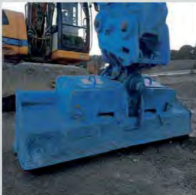
Godet "capoté" Haladjian monté sur pelle Liebherr® A918 COMPACT
