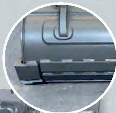
Blindages horizontaux en acier anti-abrasion de dureté adaptée aux matériaux excavés
