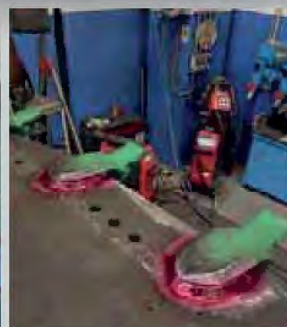
Contrôle non destructif des soudures par ressage
