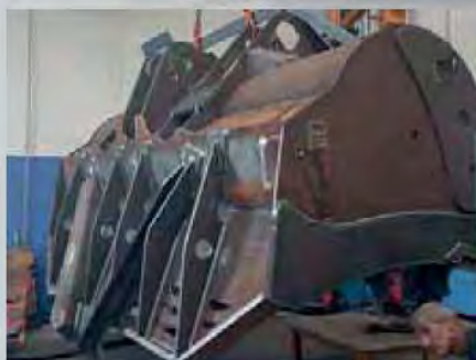
Défecteurs en V derrière la casquette pour protéger la cinématique
